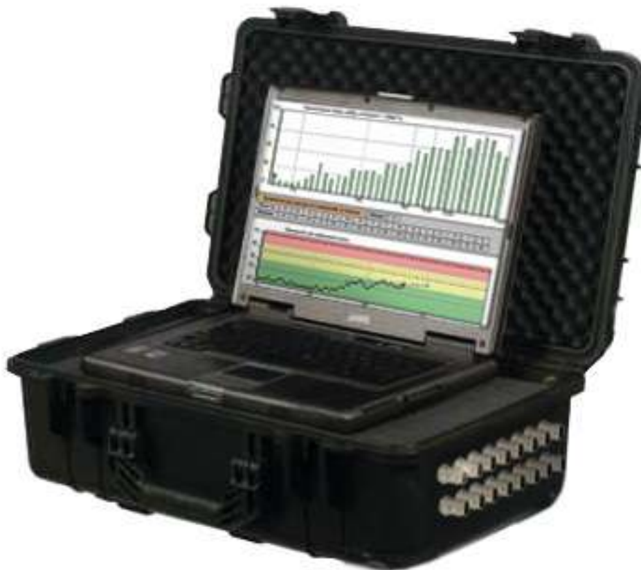
Рисунок 3.1 – Мобільна система моніторингу стану СМД - 4М
