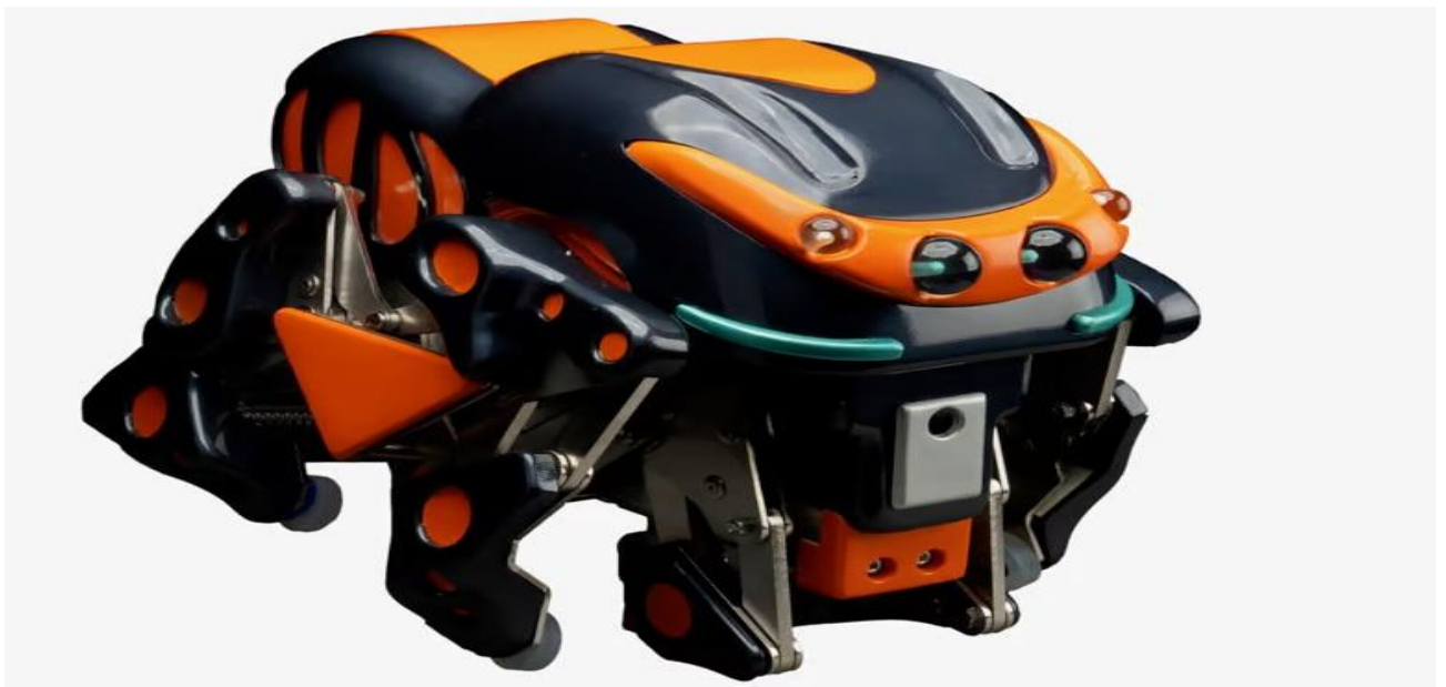
Рисунок 3.3 – Зовнішній вигляд робота-павука для огляду і ремонту каналізаційних мереж
