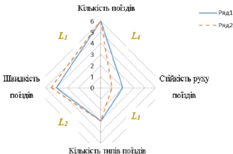
Рисунок 3.16- Результати визначення параметрів пропускнуї спроможності найбільш завантаженого напрямку при існуючих параметрах (ряд 1) та запропонованих (ряд 2)
