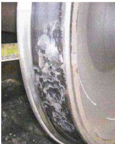
Рис. 2. Навар (а) і вищербина (б) на поверхні кочення колісних пар у разі роботи з композиційними колодками
