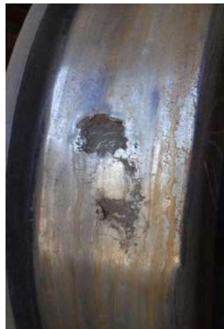
Рис. 2. Навар (а) і вищербина (б) на поверхні кочення колісних пар у разі роботи з композиційними колодками
