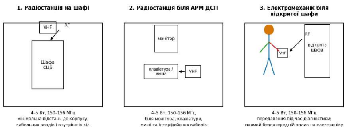
Рис. 1. Розрахункові зони можливого перевищення рівня 10 В/м для УКХ-передавачів 150–156 МГц
