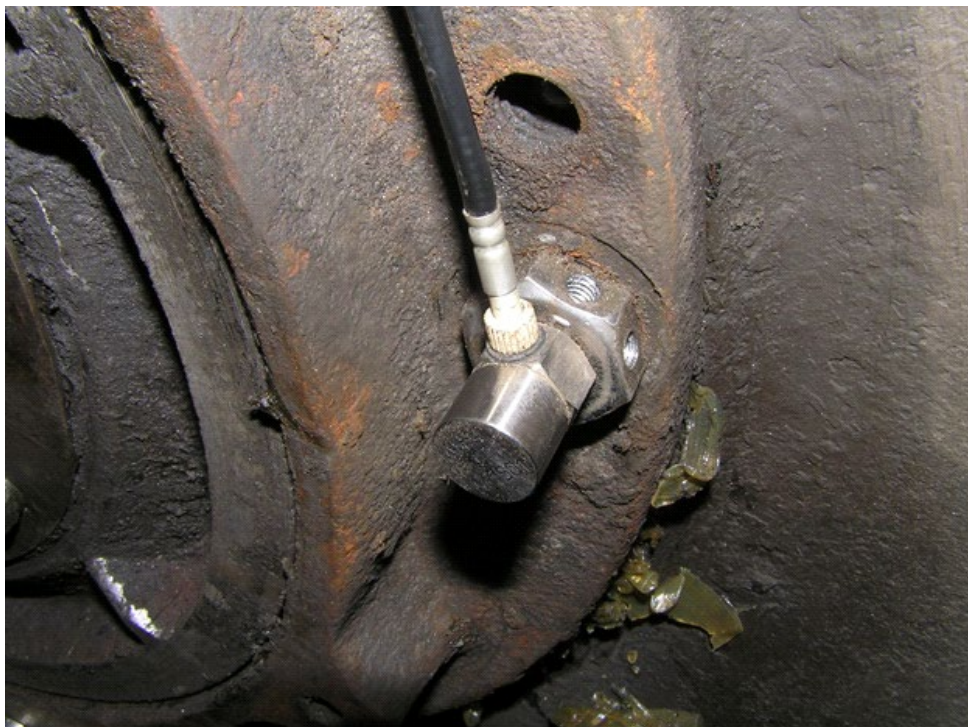
Рисунок 4.3 – Кріплення датчика до головки болта за допомогою шпильки
