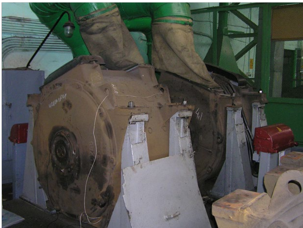
Рисунок 4.1 – ТЕД на випробувальній станції, які працюють за методом взаємного навантаження
