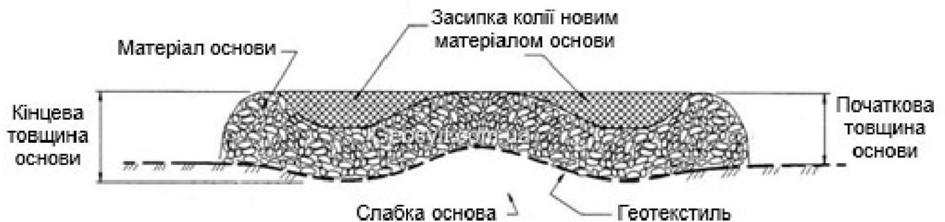
Рисунок 2.12 – Засипання колії після ущільнення шару на слабкій основі
