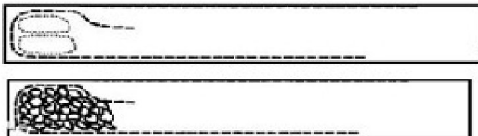
Рисунок 2.10 – Варіанти влаштування торцевих заворотів обойм із Kortex GT
