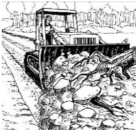
Рисунок 2.3 – Вирівнювання основи бульдозером
