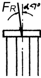
Рисунок 3.7 – Вертикальна схе- ма забивання палі
