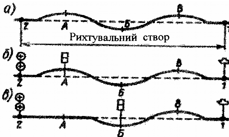
Рис. 5.7. Схема установлення зорової труби й рейок при рихтуванні прямих ділянок колії:
