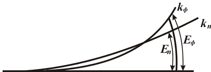
Рис. 6.6. Зсув кривої на різницю евольвент
