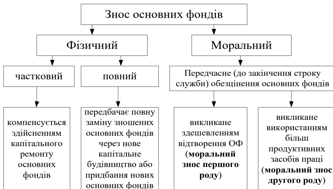
Рис. 5.3.Схема видів зносу ОВФ
