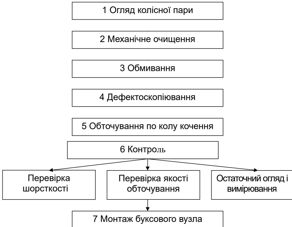
Рисунок 2 - Схема обстеження і ремонту колісних пар вагонів
