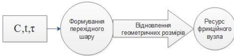
Рис. 3 – Модель технологічного процесу підвищення зносостійкості
