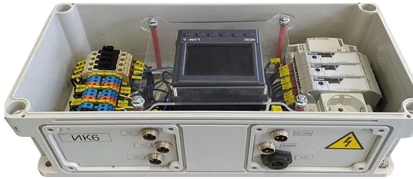
Рисунок 1.1 – Вимірювальний комплекс параметрів мережі електропостачання
