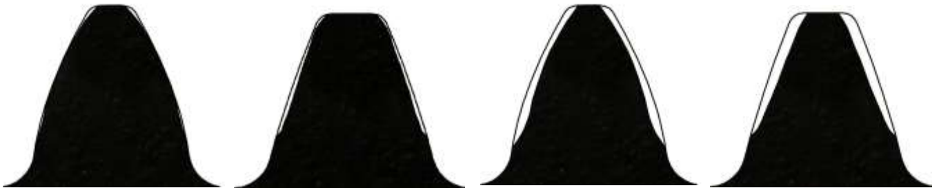
Рис.9. Зубці шестерні та колеса, які відносяться до першої групи ( \Delta_1 = 0,13\Delta_{1MAX} , \Delta_2 = 0,17\Delta_{2MAX} )
