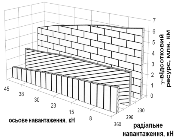
Рис. 18. Залежність зміни 90% ресурсу при наявності осевого навантаження
