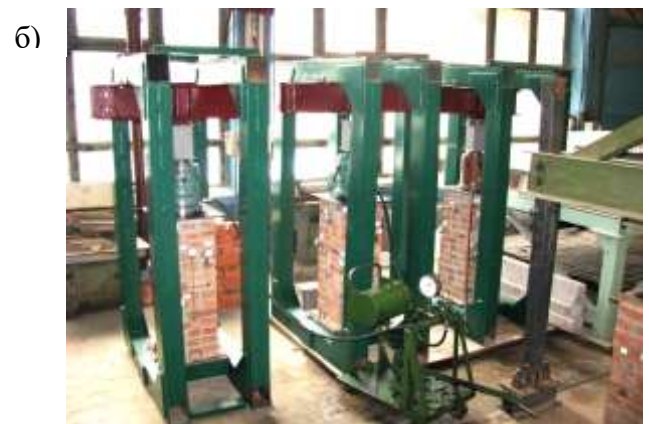
Рис. 4. Загальний вид випробувань деформаційно-міцнісних властивостей при статичному (а) та малоцикловому (б) навантаженні цегляної кладки
