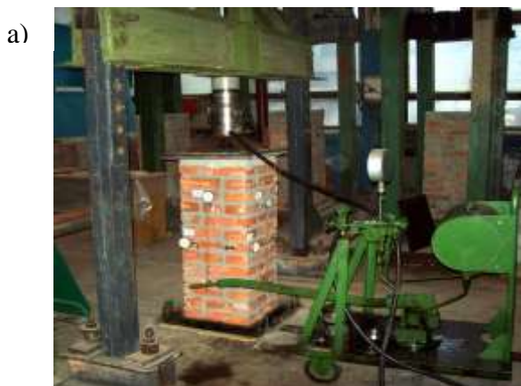
Рис. 4. Загальний вид випробувань деформаційно-міцнісних властивостей при статичному (а) та малоцикловому (б) навантаженні цегляної кладки
