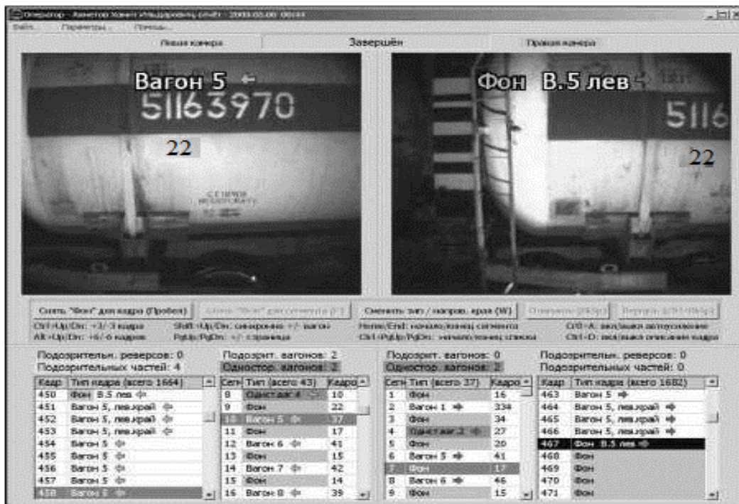
Рисунок 8.5 — Додаток ARM TO в режимі покадрової обробки списку вагонів состава
