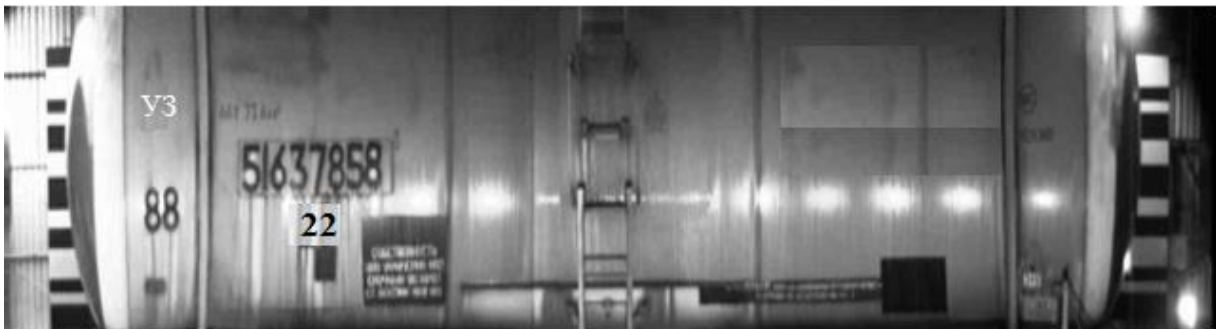
Рисунок 8.7 — Результат роботи технології прагматичної компресії – синтезований панорамний знімок вагона
