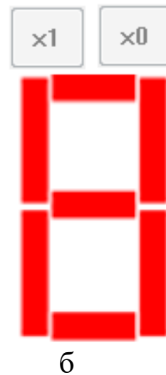
а – зображення вікна створення змінних типу BOOL; б – спрощене зображення семисегментного індикатора та двох кнопок шин сигналів x_0 та x_1
