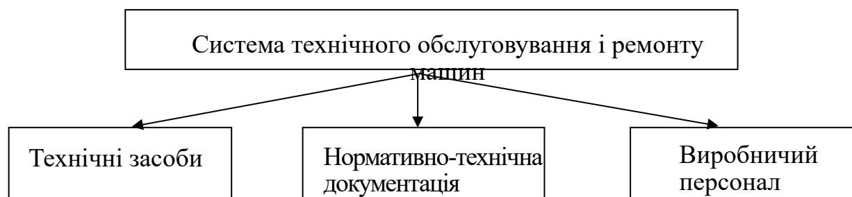
Рисунок 2 – Складові системи технічного обслуговування і ремонту машин
