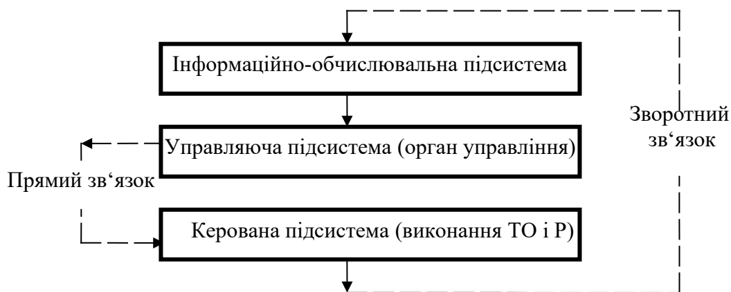
Рисунок 8 – Склад системи управління експлуатацією машин методами і засобами ТО і Р [21]
