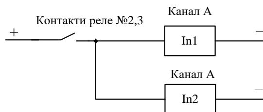
Рисунок 6.7 – Схема вводу інформації з резервуванням входів (контакти «Реле № 2» і «Реле № 3»)
