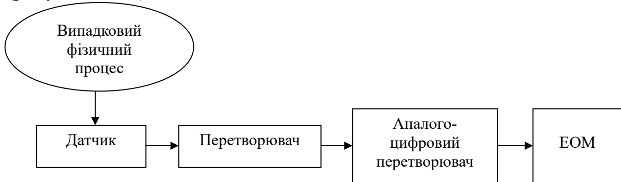
Рисунок 1.7.1 – Апаратний метод генерації випадкових чисел
