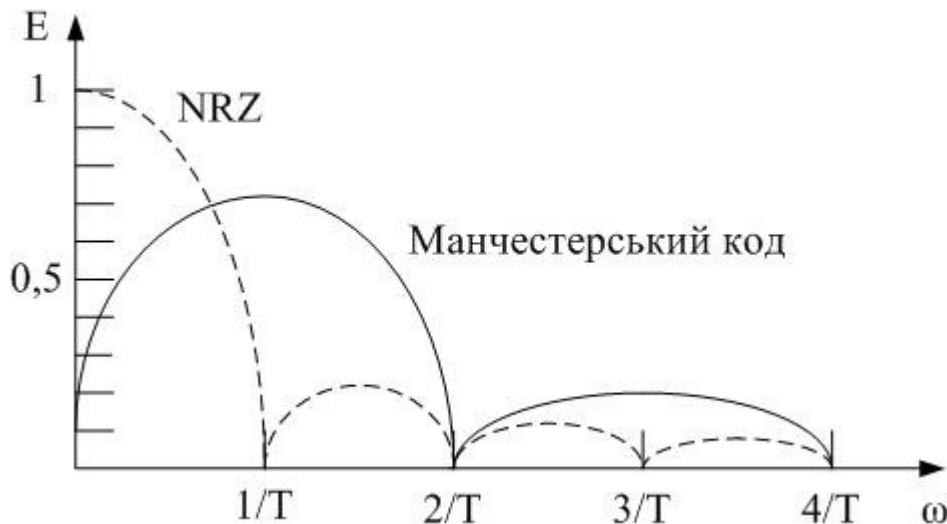
Рисунок 9 – Спектральна щільність потужності манчестерського коду
