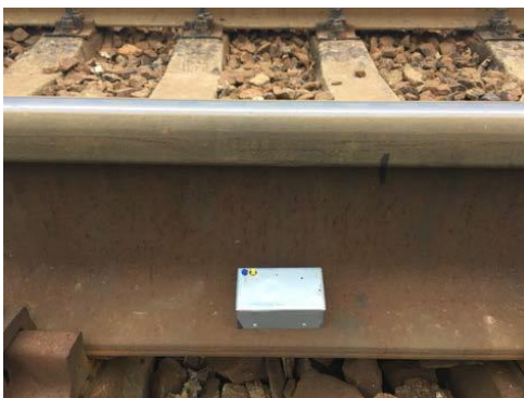
Рис. 13 – Встановлення пристрою на підшву рейки.
