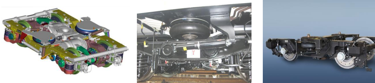
Рис. 1 – Конструкція візків електропоїздів EJ 675 («Skoda»), HRCS2 («Hyundai Rotem») та ЕКр1 (ПАО «КВСЗ»).
