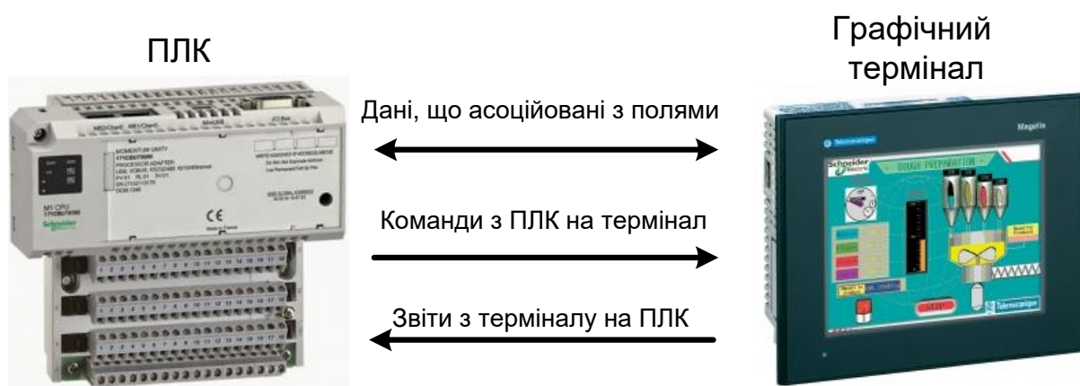
Рисунок 5 – Обмін даними між ПЛК і сенсорною панеллю
