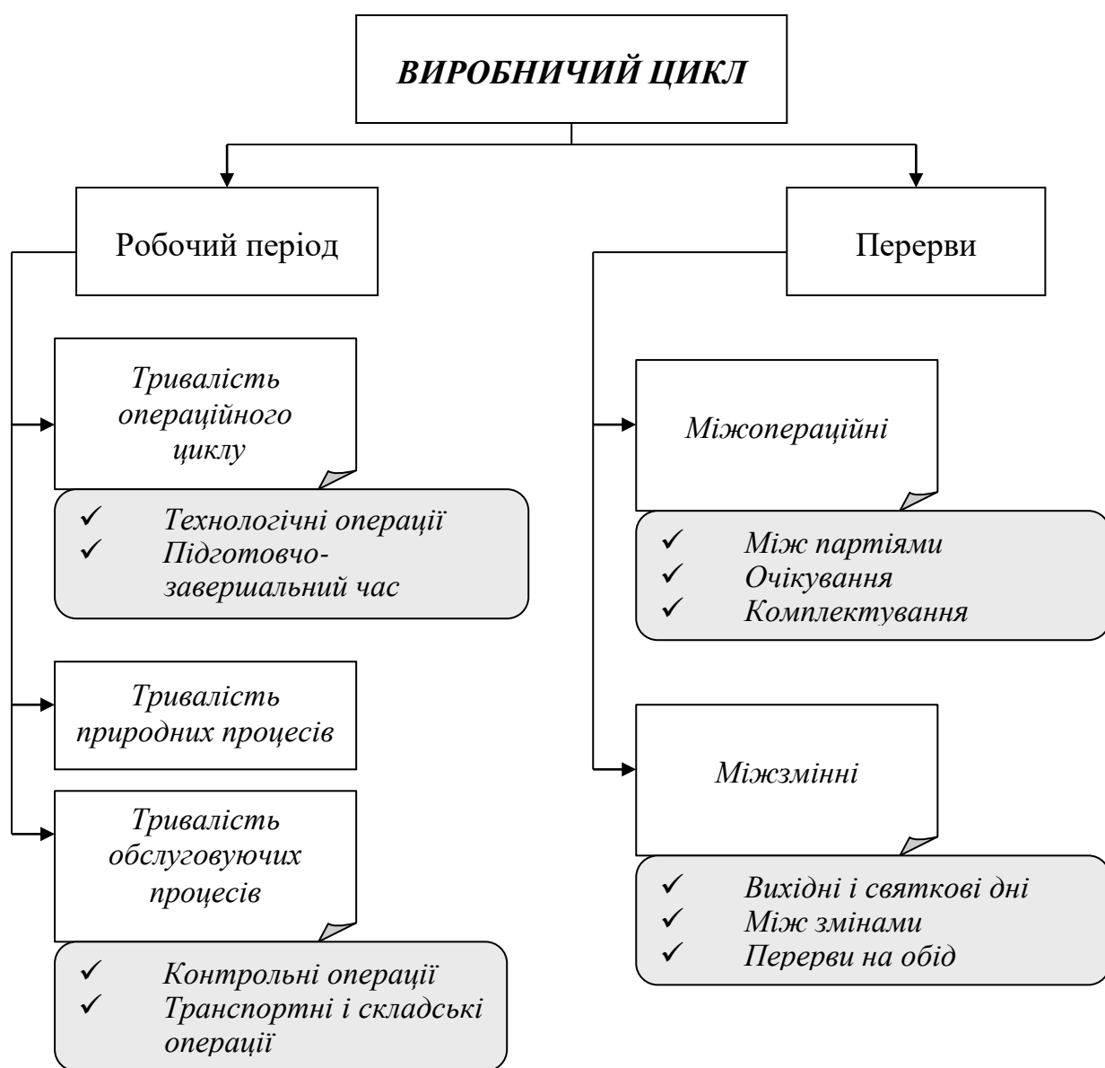
Рис. 2.4. Структура виробничого циклу
